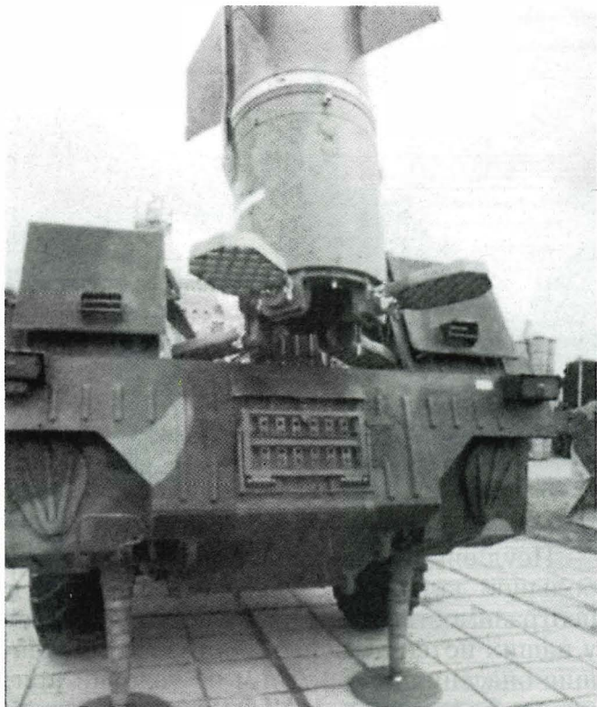
Интересной особенностью ракеты являются решетчатые поверхности управления
