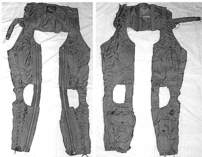
Противоперегрузочный костюм пилота "Мустанга" – воздух сжимал ноги и живот, снижая отток крови от головы при перегрузке
