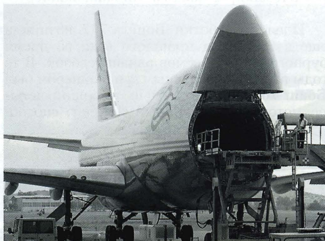
Откидная носовая рампа грузового самолета Боинг 747F
