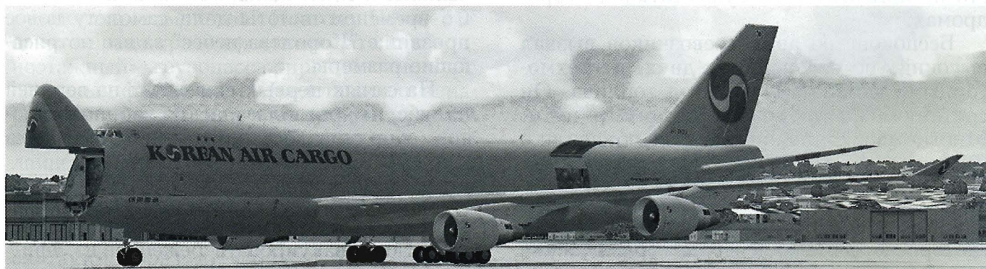
Грузовой Боинг с откидной носовой рампой и большим грузовым люком в хвостовой части фюзеляжа
