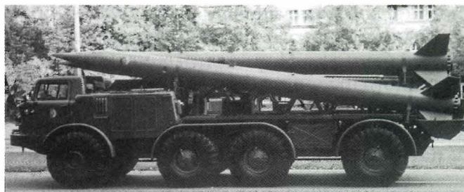
Транспортно-заряжающая машина комплекса "Луна-М" с тремя ракетами
