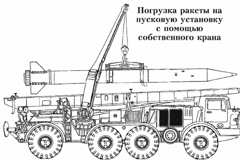
Транспортно-заряжающая машина комплекса "Луна-М" с тремя ракетами
