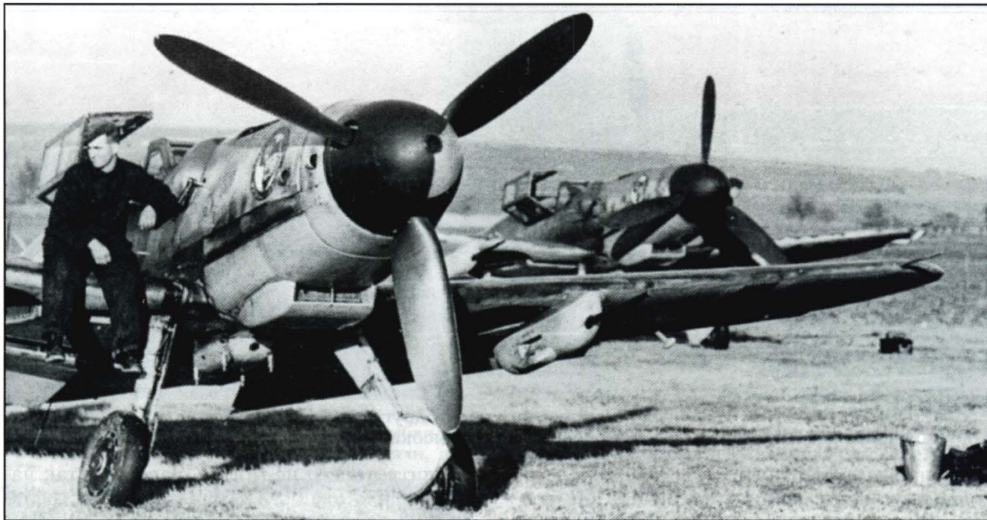
Под крылом у "Мессершмитта" видны подвесные пушки, под фюзеляжем — универсальный держатель для подвесного бака или авиабомб
